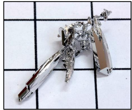
Şekil 5. Rutenyum Metalinin Gaz Fazında Büyütülmüş Kristalleri.
