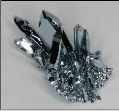
Şekil 7. Kimyasal Buhar Taşınmasıyla Oluşturulan Osmiyum Kristalleri.
