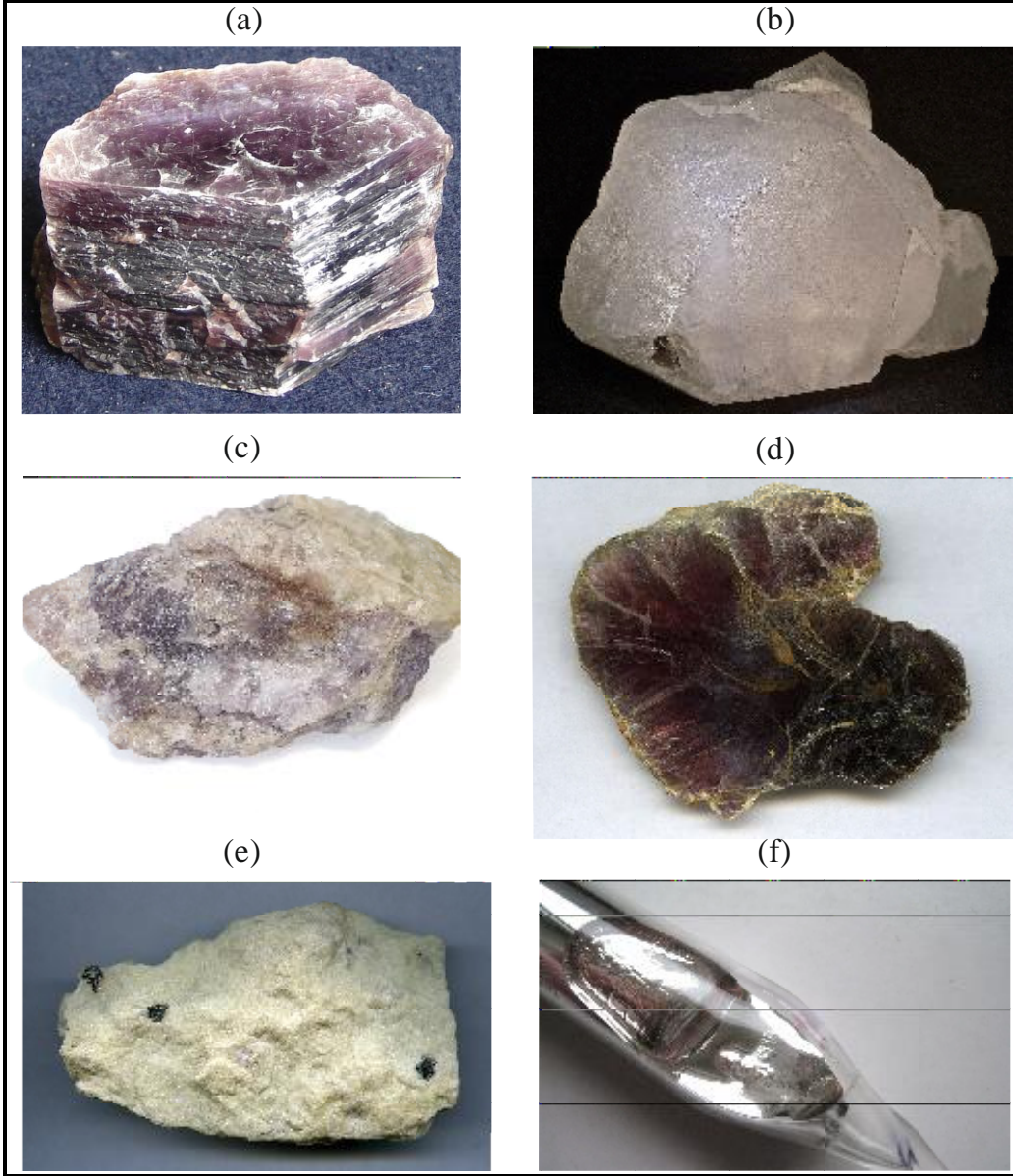
Şekil 2. Rubidyum içeren mineraller: lepidolit (a), polüsit (b), rubiklin (c), masutomilit (d), rubidyumlu muskovit (e), cam tüp içerisindeki sıvı rubidyum (f) [4] [8].
