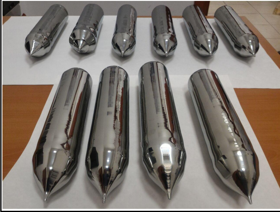
Şekil 7. Tek kristal germanyum külçeleri [20].
