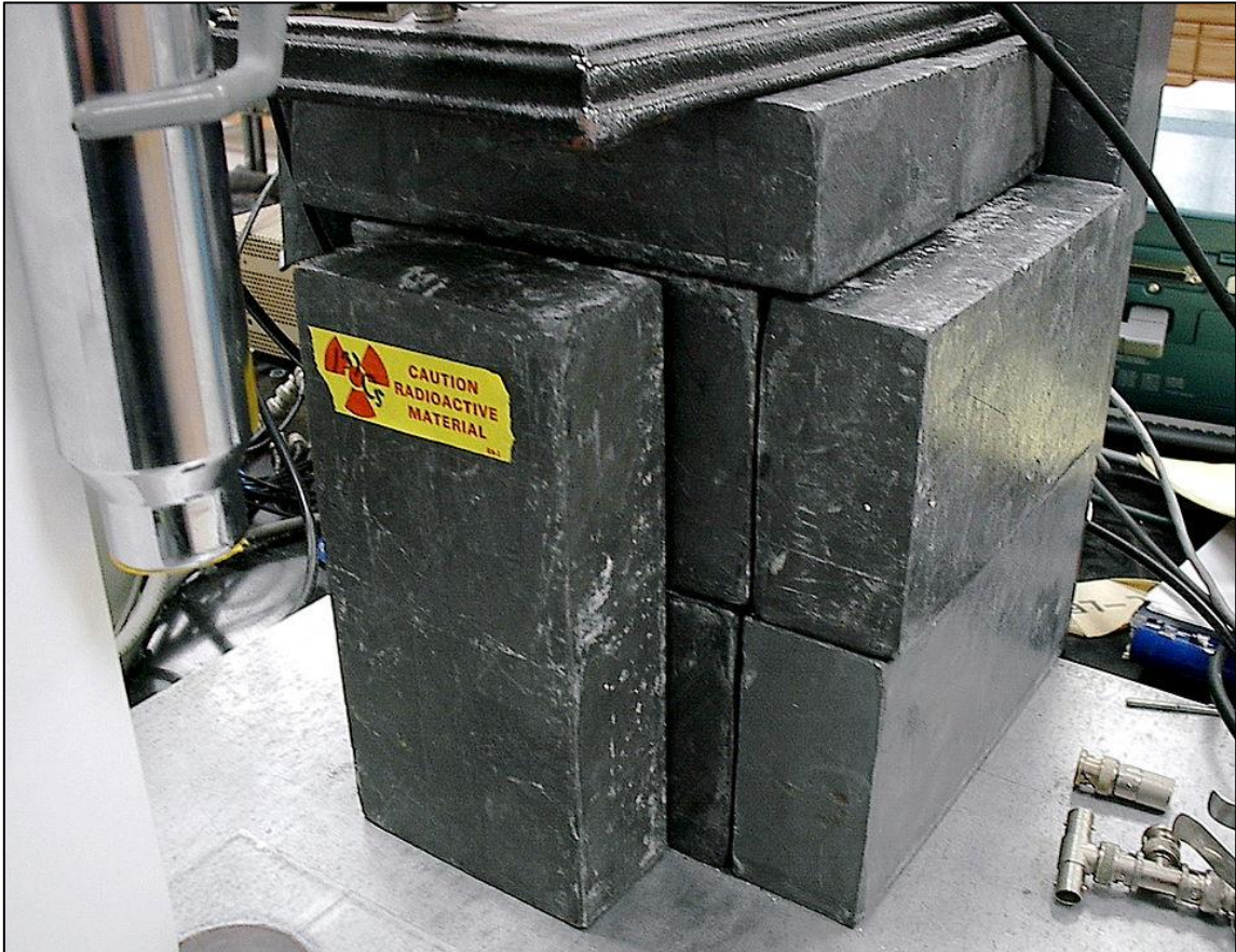
Şekil 3. Radyoaktif bir numuneyi (Cs-137) korumak için kullanılan kurşun tuğlalar [7].
