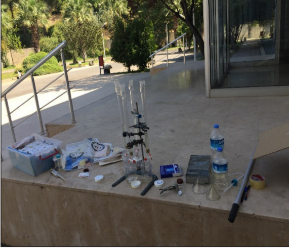
Şekil 9- Nif Çayı filtrasyon verimi deneyi ve asitlendirme işlemi.
