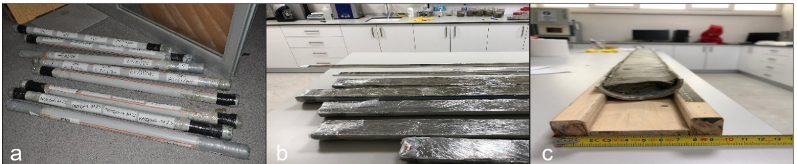
Şekil 5- a) Karotların laboratuvara gelmesi, b) Karotların yarılanması, c) Karotların temizlenerek analize hazır hale getirilmesi.
